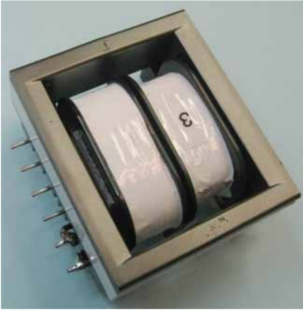
图 27. 初级绕组和次级绕组分开式集成LLC变压器的实物图片
