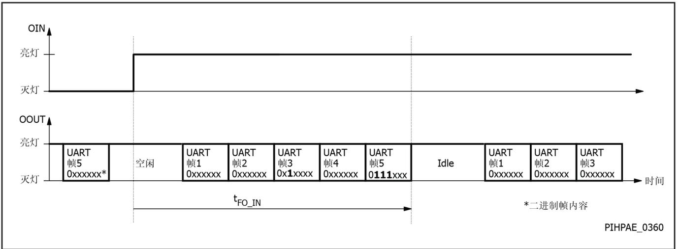
图8. 正常工作模式下的光纤状态寄存器位
