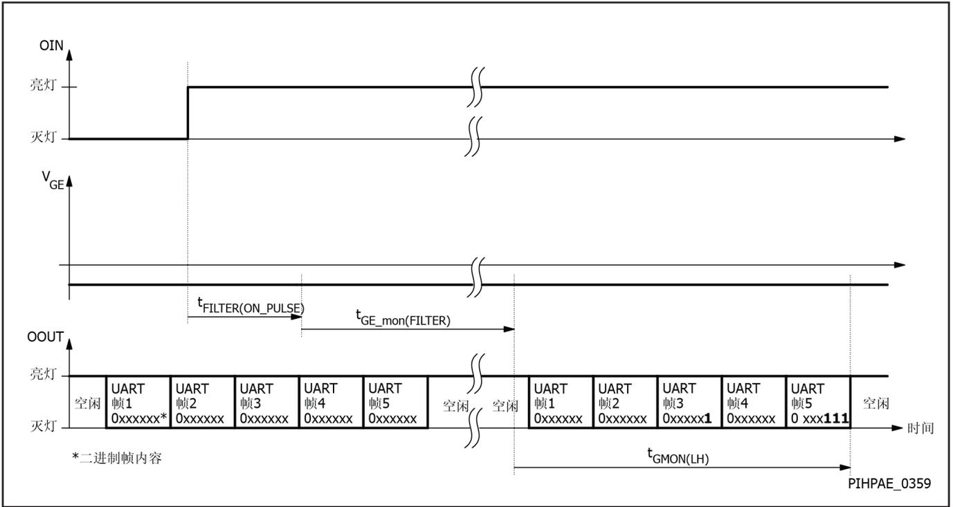
图7. 正常工作模式下的驱动器光纤反馈
