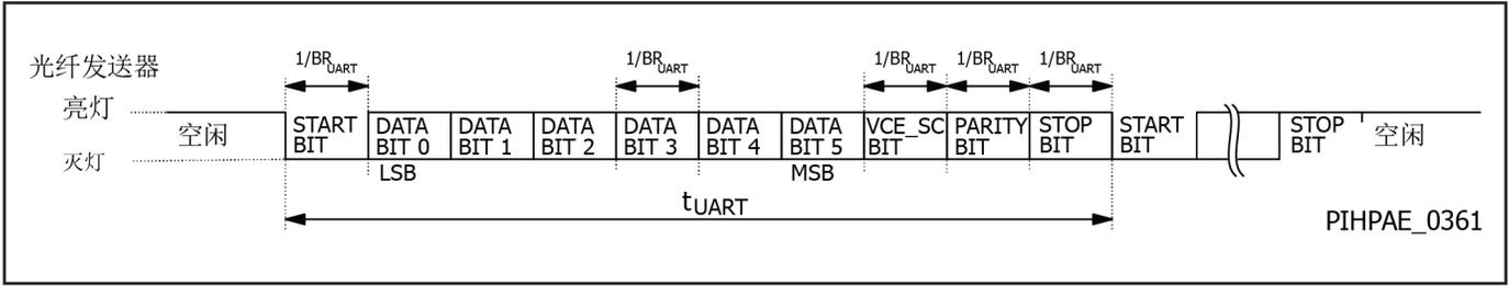
图9. UART帧时序和光纤发送器极性
