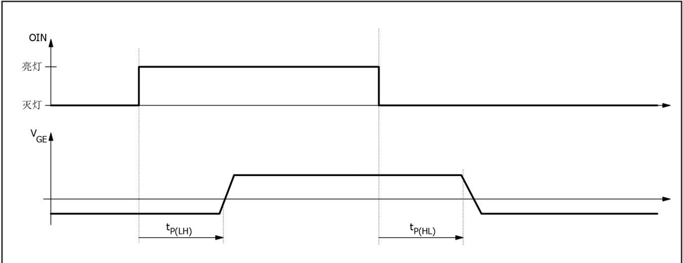
图5. 正常工作模式下的驱动器门极信号
